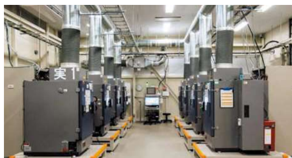
大型リチウムイオン電池高信頼性評価試験設備(充放電試験設備)
