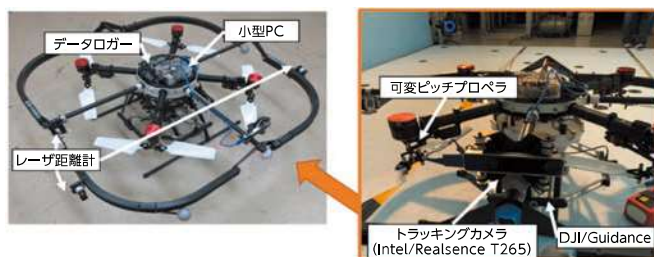
導水路無人点検用ドローン試作機
