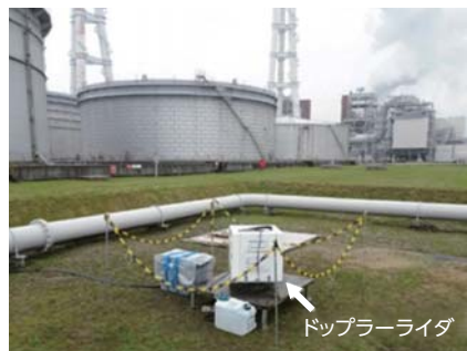
火力発電所における ドップラーライダーの実証試験
