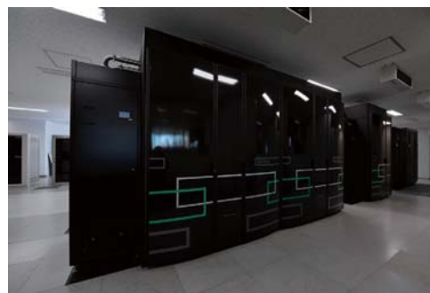
大型計算機 (HPE SGI8600) <スペック> CPUノード数:660 CPUコア数:26,400 演算処理速度:2.02PFLOPS
