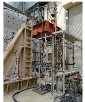
鉄塔の縮小骨組模型の耐力実験
