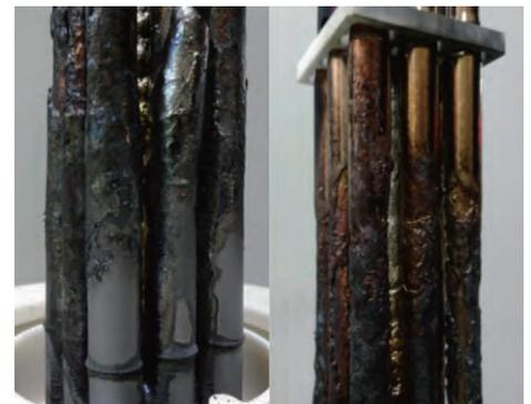
溶融試験後の模擬燃料棒の外観
