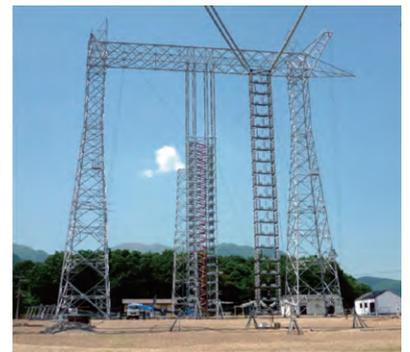
12MVインパルス発生装置(塩原実験場)
